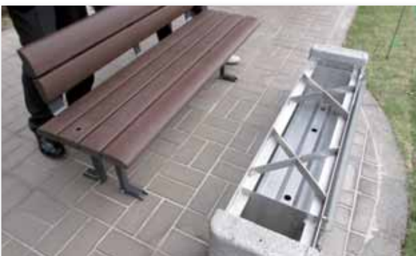
〔写真2〕防災かまどベンチ
